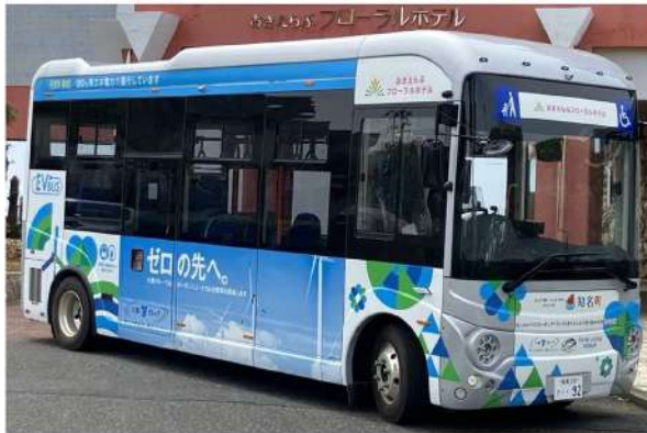
今回導入した小型電気バス EVモーターズ・ジャパン製EVコミュニティバス 全長：6.99m、乗車定員：29名（立席含む） バッテリー：114kWh、航続距離：290 km
