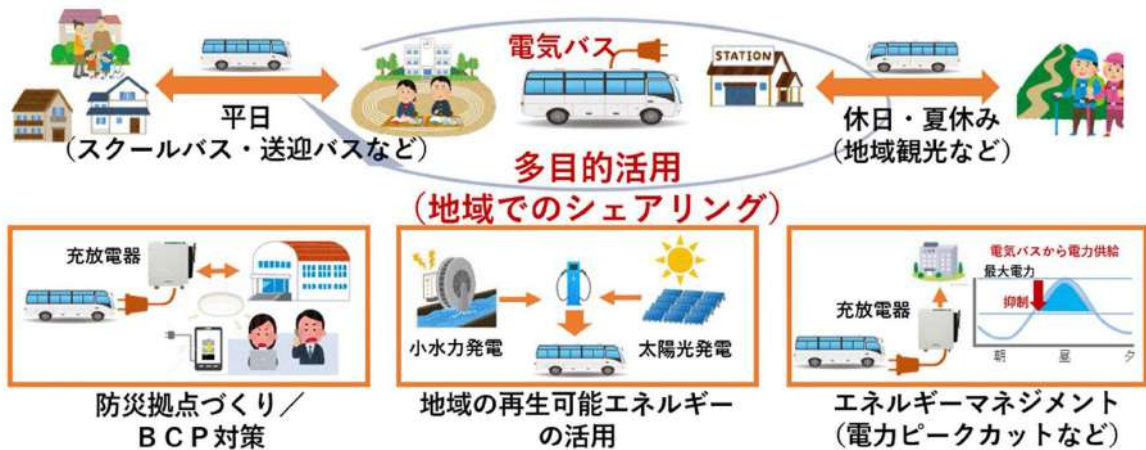
今回導入した小型電気バス EVモーターズ・ジャパン製EVコミュニティバス 全長：6.99m、乗車定員：29名（立席含む） バッテリー：114kWh、航続距離：290 km
