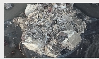
↑油脂で閉塞した下水管
